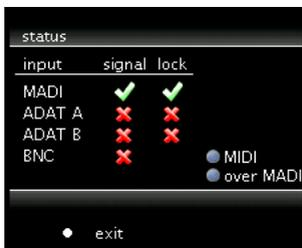
按下 **MENU**（菜单）键后选择” status”（状态）可以到达状态显示界面，从中可以看到每个数字输入的情况：设备是否接收了有效信号（” signal” 栏），信号的采样率是否正确（” lock” 栏）。只有当两个条件都符合时，A16 MK-II 才会使用该信号。
