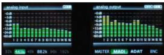
TFT 主屏幕显示 A16 MK-II 的所有32个通路、采样率的基本设置以及来自主设备的输入信号状态。另外，屏幕右上角显示接口的模拟输入 / 输出路由状态。
