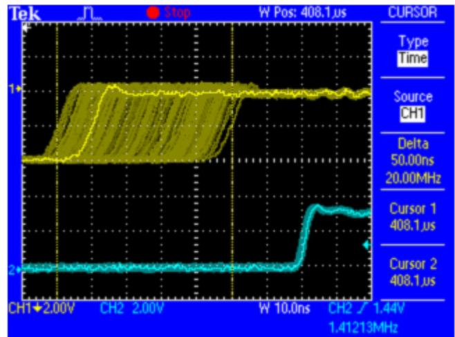
右图显示的是一个抖动达到 50 ns 的 SPDIF 信号（上面的黄色曲线）。SteadyClock 可以将抖动降到 2 ns 以下（下面的蓝色曲线）。当然，SteadyClock 处理的信号不仅用于内部，也用于数字输出时钟。因此这种处理过的无抖动信号可以用作参考时钟。
