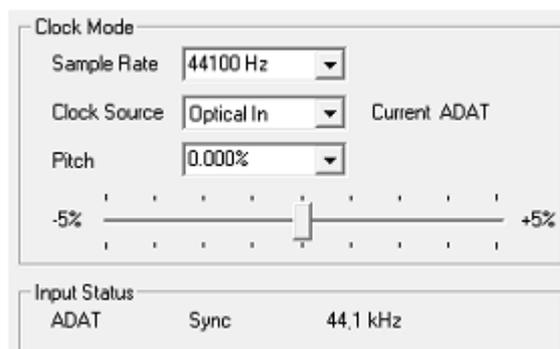
这样，可以容易地配置数字录音所需要的音频应用程序。选择了需要的输入后，**Fireface UC** 显示当前的采样率。利用应用程序的音频对话框，可以更改该参数。
