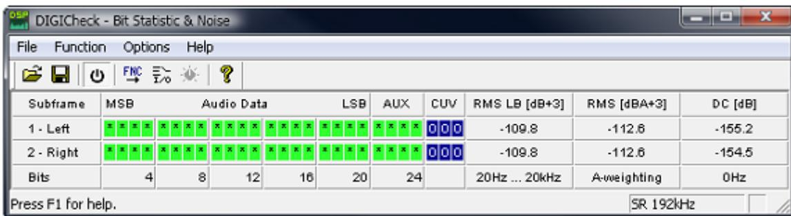
其主要原因是模拟数字转换器的噪声整形技术。这种技术可以使所有噪声和失真处于 24kHz 以上的高频范围，而人的耳朵是听不到这个频率范围的声音的。这样做可以得到非常高的性能和音频清晰度，但与此同时超声波领域的噪声也会增加。高频噪声具有很高的能量。在双倍速或四倍速模式下，宽频测量设备会显示信噪比降低，但是在人耳的可听范围内，噪声不会有任何变化。
