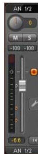
在“视图选项”/“Routing”中，可以开启或关闭所有通道的增益微调功能。在使用 TotalMix FX 作为现场调音台时，最好打开所有通道的增益微调功能。
