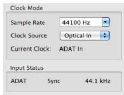
利用 RME 独创的 SyncCheck 技术(最初用于 Hammerfall)，可以容易地检查和显示当前的时钟状态。“输入状态”可以显示每个输入（Word Clock，ADAT，SPDIF 和 LTC）是否存在有效信号（Lock，No Lock）或者有效的同步信号（Sync）。“时钟模式”则可以显示参考时钟（当前）（见 31.1）。
