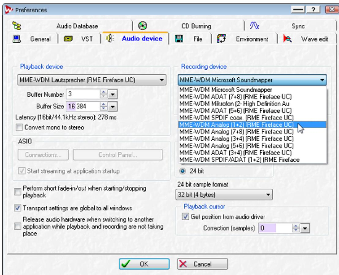
加大“缓冲值”（**Buffer Number**）或者缓冲区大小（**Buffer Size**）能够防止音频数据断裂，但是会使延时变长（即输出延迟）。为了实现音频或 **MIDI** 等的同步播放，应勾选“**Get position from audio driver**”（从音频驱动获取位置）。
