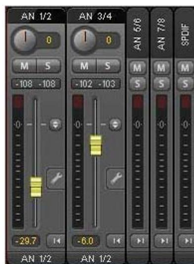
点击下面的箭头可以将通道宽度缩小到电平表的宽度。再次点击箭头，则通道宽度会复原。按住 Ctrl 键的同时点击箭头，所有右面的通道会同时放大或缩小。
