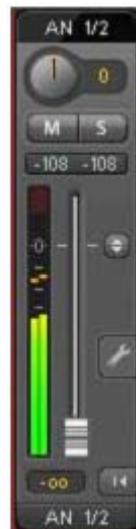
**推子**：决定分配到当前路径（下面的标签）的信号的增益和电平。应该注意的是，推子不是通道的推子，而是当前路径的推子。与标准的调音台不同，TotalMix 没有通道推子，有的只是“Aux Sends”（辅助输出），其数量与硬件输出的数量相同。这就是为什么 TotalMix 可以创建与硬件输出相同数量的子混音组。在子混音视图下能够更容易了解这个概念。
