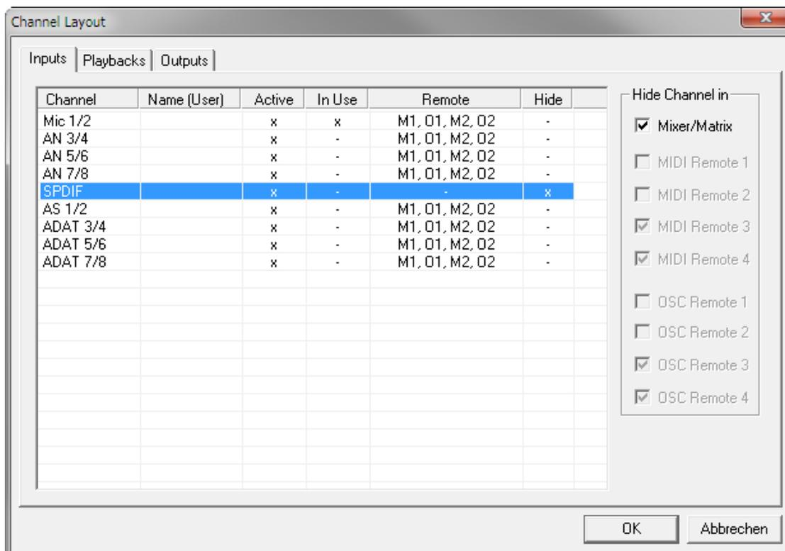
在上面的例子中，**SPDIF** 输入通道已经被隐藏。当不使用 **SPDIF** 时，这是将其从混音器中移除的简单办法。还可以进行更复杂的设置，例如只显示所有鼓、号或小提琴的通道。
