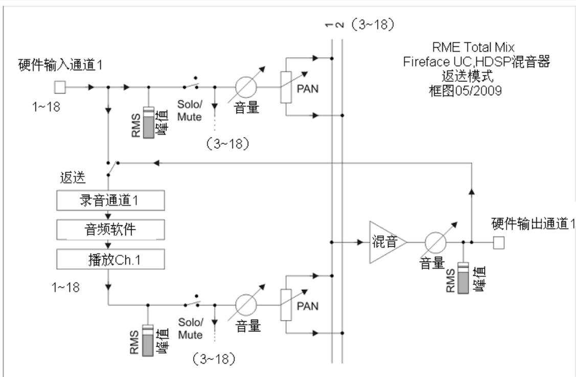
从上面的框图可以看到软件的输入信号如何播放以及如何从硬件输出回授到软件输入。
