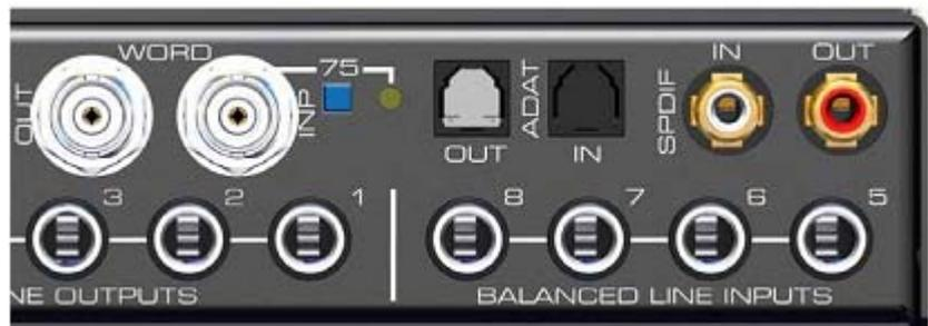
数字时钟 I/O (BNC): 可启用内部终止(75Ohms)。启用终止后,开关旁边的黄色 LED 指示灯亮起。
