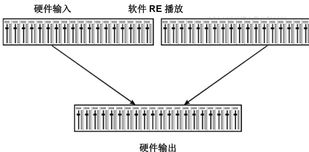
使用 TotalMix 时可以采用上图所示的界面（“视图选项” / “双行”）。输入通道应处于相应的输出通道的上方。但是，默认界面是一个类似类似于 Inline 串接式调音台的三行界面，其中软件播放通道行等同于实际调音台的 Tape Return（录带返回）通路。
