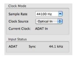
RME 独有的 SyncCheck 技术(先在 Hammerfall 里实施)易于使用当前时钟状态的检查和显示。 SyncCheck 显示是否每个输入(Word Clock,ADAT,AES)有一个有效的信号(Lock,No Lock)),或者是否有一个有效和同步的信号(Sync)。在时钟模式区域显示时钟基准。见章节 32.1。
