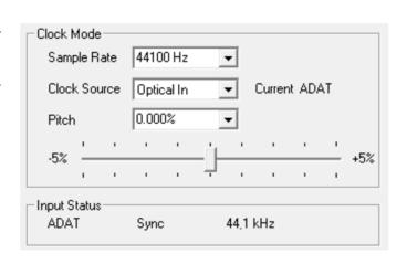
这种方法,使为数字录音配置任何适当的音频应用程序变得简单。选择正确的输入以后,Fireface UFX 显示当前的采样频率。这个参数可以在应用程序的音频属性(或类似的)对话框里改变。
