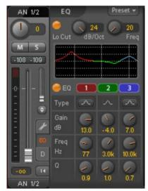
频率图形给出一个滤波器结果的精确综述。重叠滤波器相互影响。这可用来实现超过20dB的振幅,或形成困难频率响应优化。但是图像不显示低切滤波器引起的变化。注释: TotalMix有一个24dB的内部电平储备。与重叠过滤器一起极度提升可能因此导致一个内部过载。在任何情况下,这样一个过载都会通过通道电平仪的Over LED显示。
