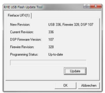
当更新意外失败时(状态: failure), Safety BIOS 会在下次开机时使用,设备保留所有的功能。闪烁过程应该再试一次。
