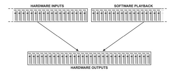
TotalMix可用于上述视图(查看选项2行)。输入通道应放在相应的输出通道上。然而,在三行里默认是一个垂直对齐以区别于内联台,因此*软件播放*行相当于真正混音台的*磁带回放*:
