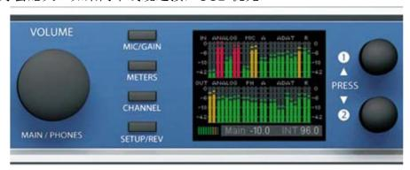
四个按键、两个编码器 1 和 2、高分辨率和清晰的彩色显示器、和一个经过深思熟虑的菜单,可以使用户在没有电脑的情况下能够快速地改变和配置设备。显示器上的帮助说明和清晰标记引导用户操作所有的功能。
