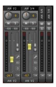
底部的箭头符号把电平仪的通道宽度变成最小。再点击一下变成最大。点击鼠标与按住Ctrl键导致所有右面的通道立刻扩大和缩小。
