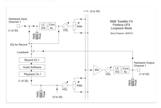
框图显示,软件输入信号如何被播放,和如何从硬件输出到软件输入。
