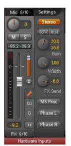
FX 发送。设置发送到传输回声和混响 FX 总线的信号的电平。当前的设置与封闭的通道设置也是可见的,因为旋钮和小推子总是同步的。为使这个功能尽可能地有用,FX 发送锁定到最高的 submix,从而模仿标准混音台的辅助后置推子功能。当移动大推子时,旋钮和小推子也都会移动。这样,混响信号会始终与干信号有相同的关系。
