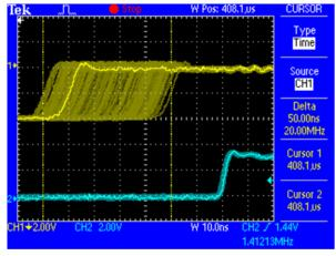
屏幕显示一个非常抖动的大约50 ns抖动(上图,黄色)的SPDIF信号。SteadyClock 用少于2ns的抖动(下图,蓝色)把这个信号变成一个时钟。SteadyClock处理的信号当然不仅是内部使用,而且还用于记录数字输出。因此刷新的和抖动干净的信号可以毫不犹豫地作为基准时钟使用。
