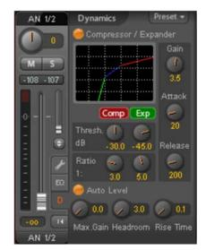
释放。为压缩器和扩展器的控制电压定义释放时间。可调范围为 100 ms 到 999 ms。振幅图形给出了一个压缩器和扩展器当前设置引起的电平变化的精确综述。自动电平。通过这个按钮激活。
