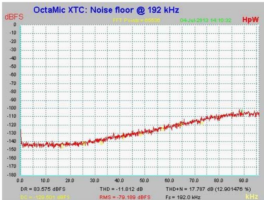
如上图所示，在30kHz以下底噪基本保持不变。当采样频率上升至96kHz时，在传送范围以外会发生噪声整形。
