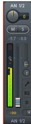
**电平表：**黄线表示峰值（电平上升时间为零，即使一个采样点也可以显示出它的满刻度电平值）。绿柱表示精确计算的RMS值。RMS有一个相对迟缓的保持时间，以更好地显示平均音量。电平过载时在顶部会出现红色提示。在首选项（Preferences）对话框（F2）中，可以设置峰值保持（Peak Hold）时间、过载检测以及参考RMS。
