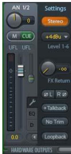
**Loopback (回路)**：将输出数据作为录音数据发送到驱动，以便录制相应的子混音。该通道的硬件输入只向TotalMix发送数据，而不再向录音软件发送数据。
