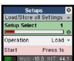
Fireface UFX+可以通过6个不同存储插槽来存储和加载当前的状态，称为Setup。从而，Fireface UFX+可以在进行相应设置以后，进入独立工作模式，能够代替很多专用设备（见第24章）。
