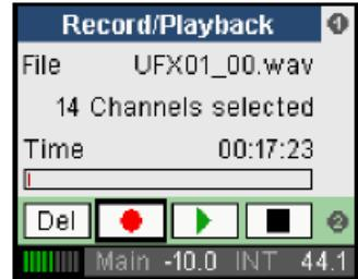
**Transport Bar** (播放控制条)。旋转旋钮2使光标在DEL、Record、Playback和Stop之间切换。按下旋钮2确认选择哪项。
