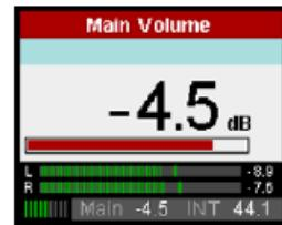
对于模拟播放端（数模转换方面），可以在TotalMix中（“Output Channel Settings”输出通道设置/“Level”电平）或直接在设备的Channel Settings（通道设置）上对后面板接口的模拟输出电平进行粗略调整。大的Volume旋钮用于控制Main Out（主输出）音量（默认：Analog1/2）。
