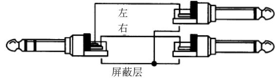
针脚配置符合国际标准。左、右通道分别连接TRS插孔/插座的“尖”和“环”。
