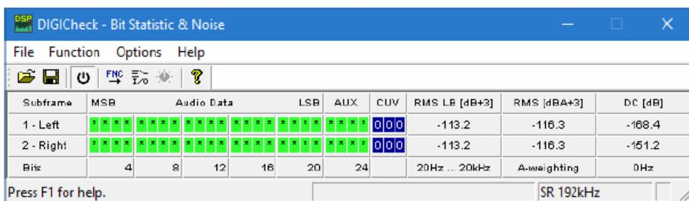
这样的主要原因是模拟数字转换器的噪声整形技术。这种技术可以将所有噪声和失真移至24kHz以上人耳听不到的高频范围。这样做可以得到非常的性能和音频清晰度，但与此同时超声波领域的噪声也会增加。高频噪声具有很高的能量。由于双倍(四倍)带宽，宽频测量设备会
