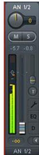
**电平表：**黄线表示峰值（电平上升时间为零，即使一个采样点也可以显示出它的满刻度电平值）。绿柱表示精确计算的RMS值。RMS有一个相对迟缓的保持时间，以更好地显示平均音量。电平过载时在顶部会出现红色提示。在首选项（Preferences）对话框（F2）中，可以设置峰值保持（Peak Hold）时间、过载检测以及参考RMS。
