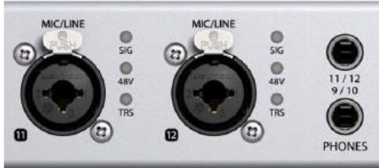
模拟输出9到12，可以馈送到耳机输出**Phones 1**和**Phones 2**。这些高质量的低阻抗输出可以驱动耳机进行无失真的高电平重放，因此无论是低阻抗还是高阻抗耳机都适用。
