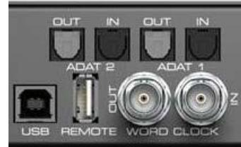
**ADAT1输入/输出。**TOSLINK。标准ADAT光纤端口，8通道。
