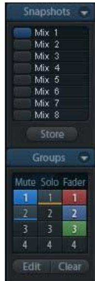
点击标题条上的箭头可以将Snapshots栏最小化。
