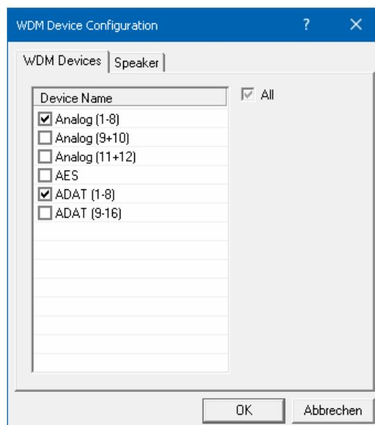
左侧的截图显示的是在选择WDM设备列表中选择了“Multi-Channel” (多通道) 后，点击WDM Configure所出现的对话框，列出了UFX II上可用的多通道WDM设备。在这个例子中，Analog 1~8以及ADAT 1~8的设备正在使用。
