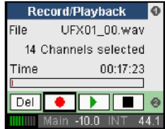
**Time** (时间)。录音时长或当前播放的位置。当在设备上按下录音键时，仍然显示的是媒体剩余可录制的时间。由于只能录制100个文件的限制，实际的录音时间会更短。在Stop和Playback模式下，旋转旋钮2可以改变当前的播放位置。
