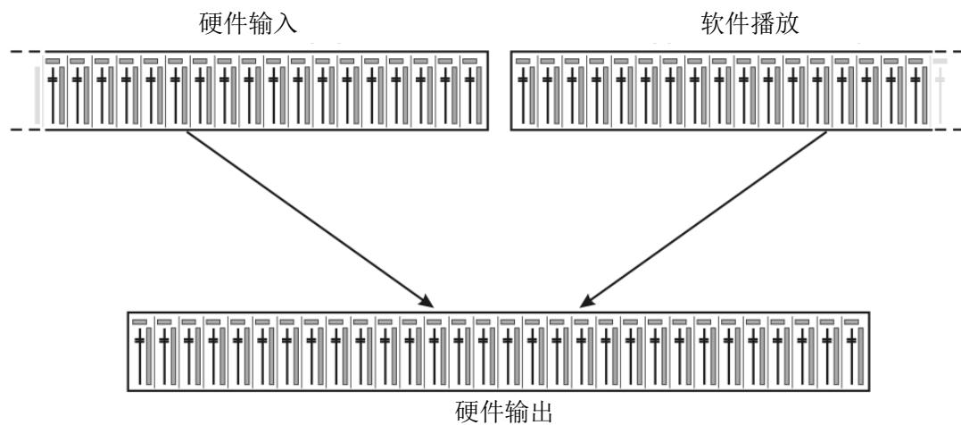
TotalMix可以采用上图所示的界面（View Options视图选项：**2行模式**）。但默认界面是一个类似于Inline串接式调音台的三行界面，其中软件播放（Software Playback）通道相当于实际调音台的Tape Return（录带返回）通路：
