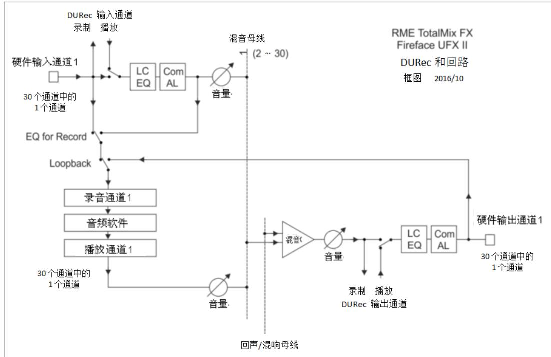
上面的框图显示的是多种情况下的信号流，Loopback、EQ for Record和Play active。图中Loopback和EQ是关闭的，开启了输入播放。
