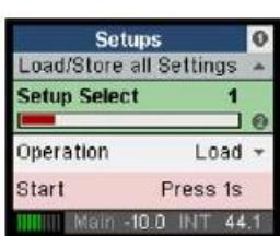
Fireface UFX II可以通过6个不同存储插槽来存储和加载当前的状态，称为Setup。从而，Fireface UFX II可以在进行相应设置以后，进入独立工作模式，能够代替很多专用设备（见第24章）。
