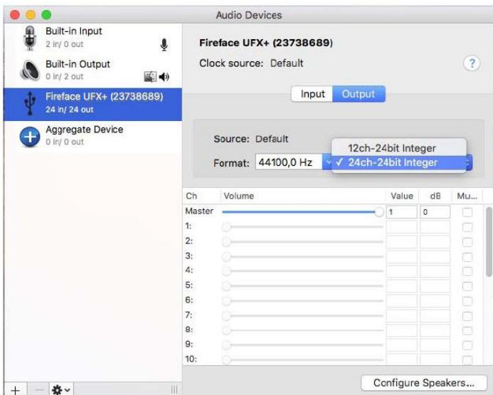
Mac OS X支持2通道及以上的USB音频2.0。UFX II提供24个输入和24个输出通道，最高96kHz。无论是在普通模式还是CC模式下，在Audio MIDI Setup中显示为“Fireface UFX II (xxxxxxxx)”。在CC模式下，没有USB Settings这一项，TotalMix将显示“disconnected (未连接)” UFX II。
