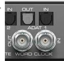
在设置对话框中选择Single Speed（单倍速）将会使输出信号始终保持在32kHz~48kHz的范围内。所以当采样频率为96kHz和192kHz时，输出字时钟为48kHz。
