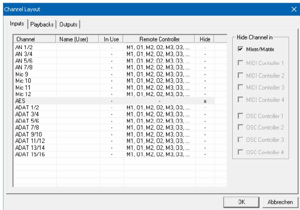
在上面的例子中，AES输入通道已经被隐藏。当不使用AES时，这是将其从混音器中移除的简单办法。还可以进行更复杂的设置，例如只显示所有鼓、号或小提琴的通道。
