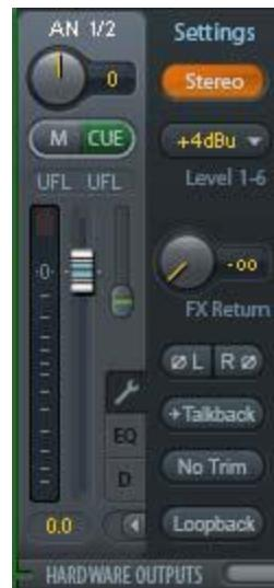
**Loopback (回路)**：将输出数据作为录音数据发送到驱动，以便录制相应的子混音。该通道的硬件输入只向TotalMix发送数据，而不再向录音软件发送数据。
