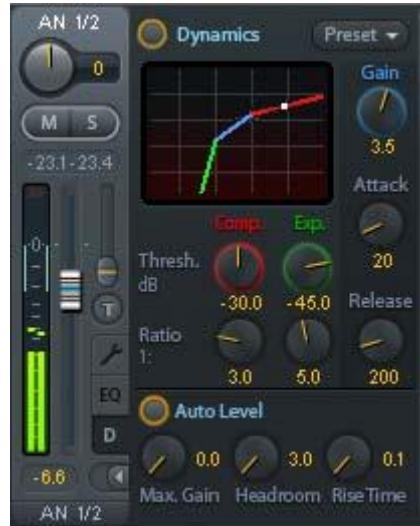
**Release**（释放时间）：定义压缩器/扩展器控制电压的释放时间。调整范围为100~999ms。
