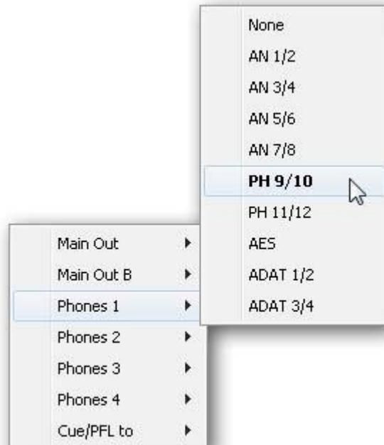
**Assign(分配)：**定义主输出、主输出B(扬声器B)以及最多四个耳机输出。只能选择ADAT3/4，
