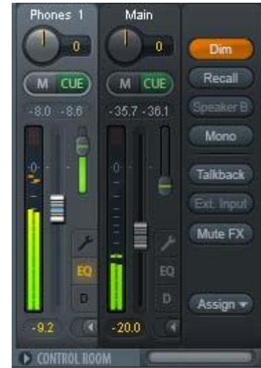
**Dim（衰减）：**音量降低。降低量取决于Settings对话框中（F3）的设定值。
