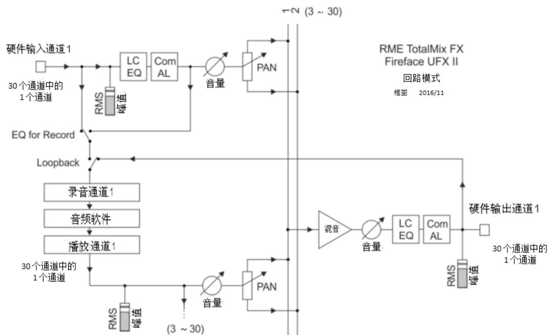
从上面的框图可以看到软件的输入信号是如何播放的，以及如何从硬件输出回到软件输入的。
