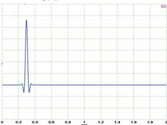
上方截图显示了DAC滤波器的模拟输出信号，测试信号为44.1 kHz采样率的数字单采样点脉冲。**Slow**（慢速）具有最完美的响应，但在15 kHz处损失约1.2 dB，见34.8节。两种**Short Delay**都是IIR型滤波器，其余两种是FIR型滤波器。FIR是在整个频率范围内为线性相位。
