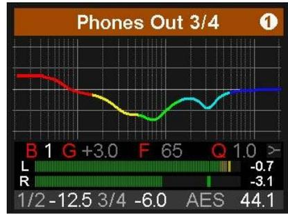
按下旋钮2将光标移到参数栏，所有参数值都变成白色。此时旋转3个旋钮即可调整所有参数。Volume旋钮改变Gain（增益），旋钮1改变Frequency（频率），旋钮2改变Q值（品质因数）。在频响曲线中可实时看到所有参数变化，以便找到最佳设置。
