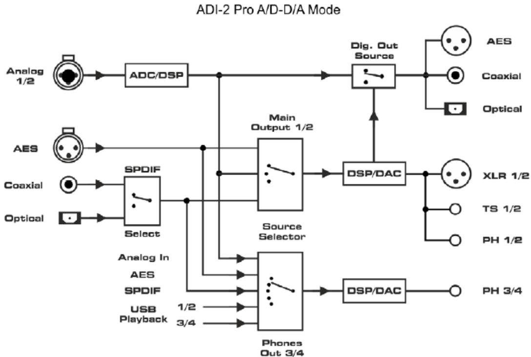
**注意:** 为了简化框图, USB 录音并未在图中提现。在所有模式下, 所有输入信号都会通过 USB 发送到主机上。在多通道模式下有三对独立的立体声输入 (Analog/AES/SPDIF), 在立体声模式下只有一对模拟立体声输入。
