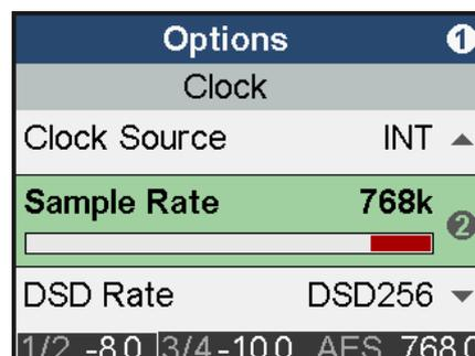
当时用352.8或384 kHz作为采样率时, 电平表会显示一个单通道音频从SPDIF发送出去, 或是当连接到一个192kHz采样率信号时显示接收到一个单通道音频。这是因为ADI-2 Pro具有一个特殊的SMUX模式。当以Octa Speed (八倍速) 运行时, ADI-2 Pro会将模拟输入左通道, 以192 kHz 分流并输出到 AES/SPDIF 输出通道的左和右。使用像 [HpW Works \(www.hpw-works.com\)](http://www.hpw-works.com) 支持此模式 (2x 倍速) 的测量软件和任意支持192 kHz的RME音频接口, 我们都可以至少在一个模拟通道上实现SPDIF上384 kHz采样率带宽的模拟测量。
