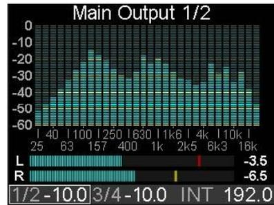
你可能注意到在DSD模式下，变更播放曲目时会经常听到咔哒声，即使下一个曲目的采样率与当前的完全一样。这是由于1-bit格式导致的，与PCM不同，它在曲目的开始和结束需要绝对安静的自由转换，所以根据1-bit流的要求，传输并不代表一个随机信号，听起来像咔哒声一样。但很多自由的可用音轨在开始和结束时不“干净”。如果将它们用播放器软件一一播放，那么ADI-2 Pro FS的电平表将表明我们听到的噪声不是ADI-2 Pro FS产生的，而是DAC将它看成了一个信号播放出来了。电平表是在DAC之前的数字域的，所以很容易检查出错误的输入信号。
