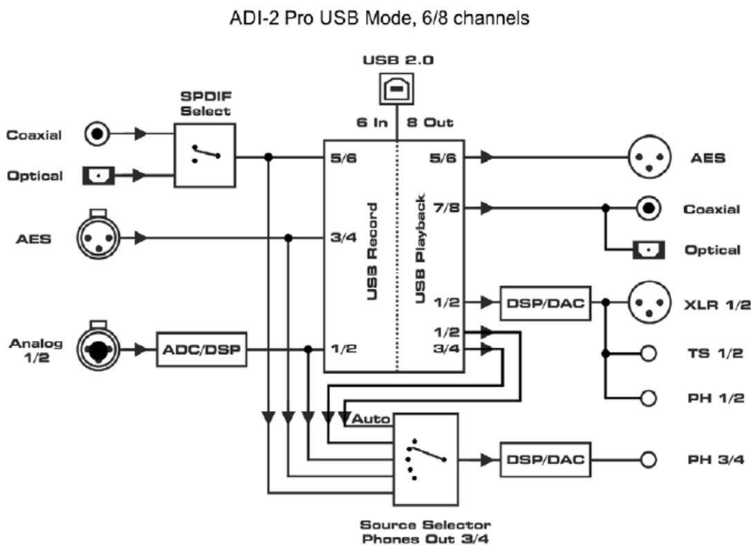
选项 *Digital Out Source*（数字输出源）- *Main Out*（主输出）（SETUP “设置” - Options “选项” - Hardware/Diagnosis “硬件/诊断”）将处理后的信号 Main Out 1/2 发送到数字输出 AES、SPDIF 和 ADAT，比如发送至具有数字输入的监听设备。播放通道 5/6 和 7/8 不能再使用。
