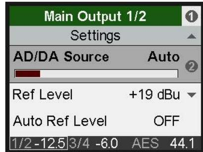
因此AD/DA Source这一项通常为灰色。只有在AD/DA和DAC模式下输入信号可以在Auto（自动）、SPDIF、AES和Analog.（模拟）之间选择。因此可以选择任意当前连接的所有数字输入信号转换到输出1/2。
