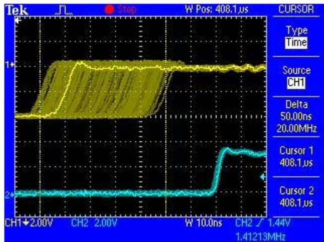
SteadyClock可以将信号转换到2 ns以下抖动的时钟（下方蓝色曲线）。SteadyClock处理的信号不仅用于内部，也作为数字输出的时钟。因此更新的、无抖动的信号完全可以作为参考时钟信号。
