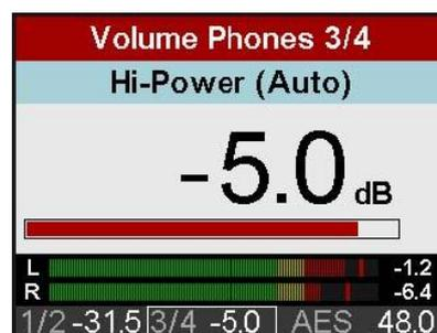
**注意：**重新定义量程只有当超过了最高的非失真电平之后才会进行。重新定义的量程会一直显示，直到耳机从插口拔出。持续的过载情况会使屏幕显示Overload（过载）警告，并使耳机输出断开连接。
