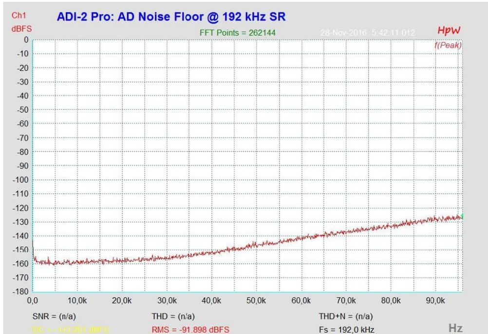
就像在专业数字音频工作站中常见的一样，ADI-2 Pro的电平表的频带限制在40 kHz，所以不会显示768 kHz和DSD的过大噪声电平，但会显示音频范围内（或略高的范围内）的所有信息。
