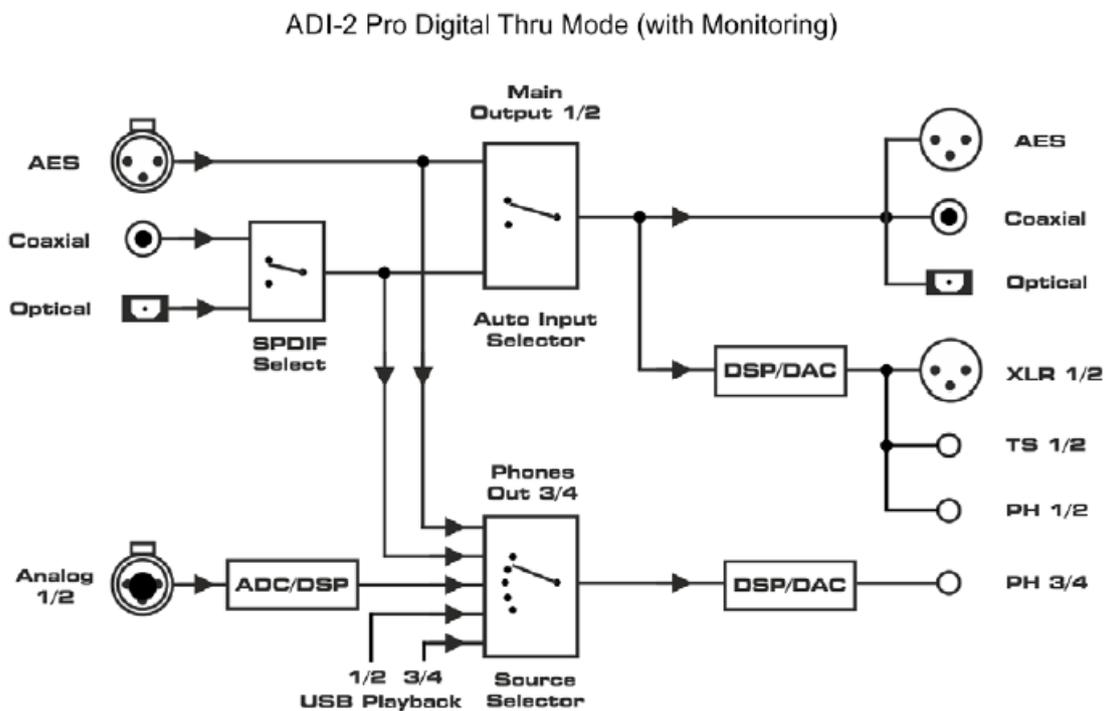
注意：为了简化框图，USB录音并未在图中提现。在所有模式下，所有输入信号都会通过USB发送到主机上。在多通道模式下有三对独立的立体声输入（Analog/AES/SPDIF），在立体声模式下只有一对模拟立体声输入。
