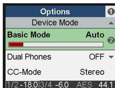
如果Dual Phones开启, 且插入了两个耳机, 按下Volume旋钮可以选择控制对象: 1/2、3/4以及联动音量控制 (此时1/2和3/4均有方框标记)。旋转Volume旋钮时, 进入Dual Volume界面。
