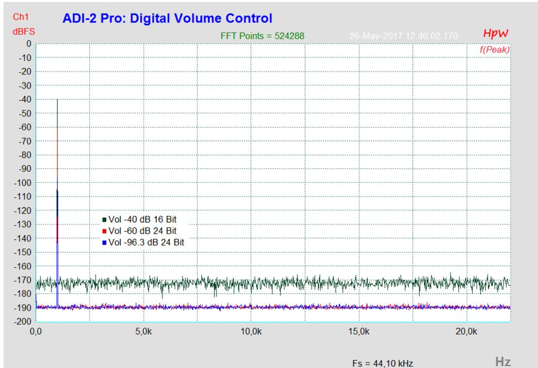
像HPW Works这样的高分辨率FFT能够将信号分解成单个频率，将不需要的频率成分的电平定义到-190 dBFS。测量显示无抖动的16 bit信号不会产生任何高于-170 dBFS的失真或其他频率的音。所以在-40 dB的音量设置下，可测量的THD为-130dB。24 bit时，-60 dB的音量设置下也能够获得无失真的-130 dB。-96.3 dB的音量设置下，可测量的THD也有-93 dB。
