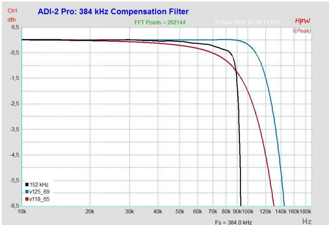
蓝色曲线为RME在384 kHz采样率下的数字补偿滤波器效果。频率响应在90 kHz之前都是平直的，没有出现像192 kHz采样时的明显衰减。有了这个滤波器，ADI-2 Pro可以以最高的精度（零点几分贝）完美地测量任意192 kHz工作设备了（当然可以测量更低采样率设备）。
