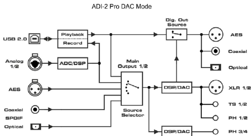
选项*Digital Out Source*（数字输出源）-*Main Out*（主输出）（SETUP“设置”-Options“选项”-Hardware/Diagnosis“硬件/诊断”）将处理后的信号Main Out 1/2发送到数字输出AES、SPDIF和ADAT，比如发送至具有数字输入的监听设备。
