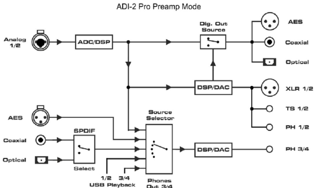
**注意：**为了简化框图，USB录音并未在图中提现。在所有模式下，所有输入信号都会通过USB发送到主机上。在多通道模式下有三对独立的立体声输入（Analog/AES/SPDIF），在立体声模式下只有一对模拟立体声输入。
