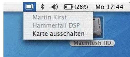
移除CardBus卡首先要点击菜单中的“Power off card”（关闭卡的电源）。Mac OS内部会卸载CardBus卡，并切断它的电源（红色主LED灯开始闪烁）。现在可以将卡从PCMCIA插槽中拔出。
