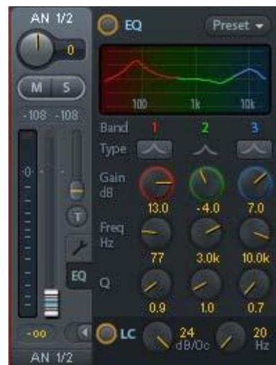
频率曲线可以精确地显示滤波结果。重叠的滤波器相互影响。这可以用来获得20dB以上的振幅或者进行较难的频响优化。
