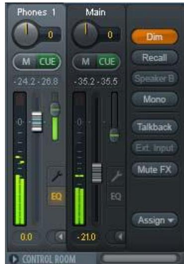
**Mono（单声道）：**对于左、右通道进行混音。可用于检查单声道兼容性以及相位问题。
