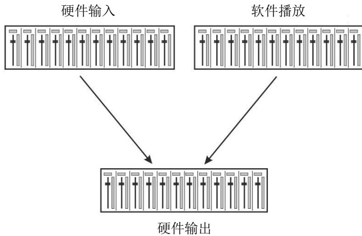
TotalMix可以采用上图所示的界面（View Options视图选项：2行模式）。但默认界面是一个类似于Inline串接式调音台的三行界面，其中软件播放（Software Playback）通道相当于实际调音台的Tape Return（录带返回）通路：
