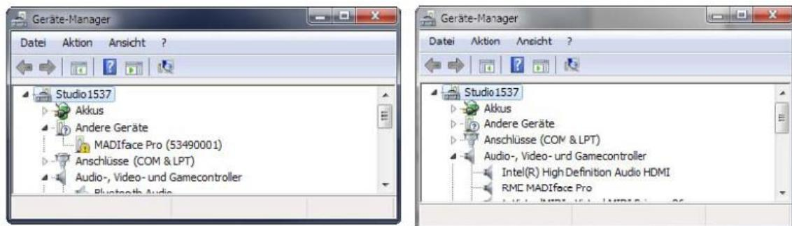
Windows不直接支持USB Audio 2.0。在CC模式下，MADIface Pro将被自动探测，但是无法自动安装驱动。
