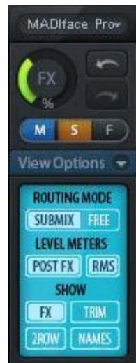
撤消/重做还适用于 **Workspace (工作区)** 之间。**Workspace** 载入完全不同的混音器视图后，可以通过点击“撤消”回到之前的内部混音器状态，但是新的混音器视图仍然存在。
