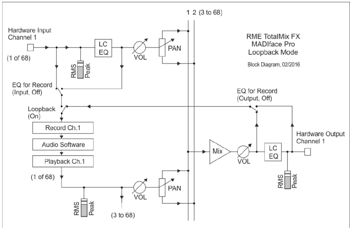
从上面的框图可以看到软件的输入信号是如何播放的，以及如何从硬件输出回到软件输入的。
