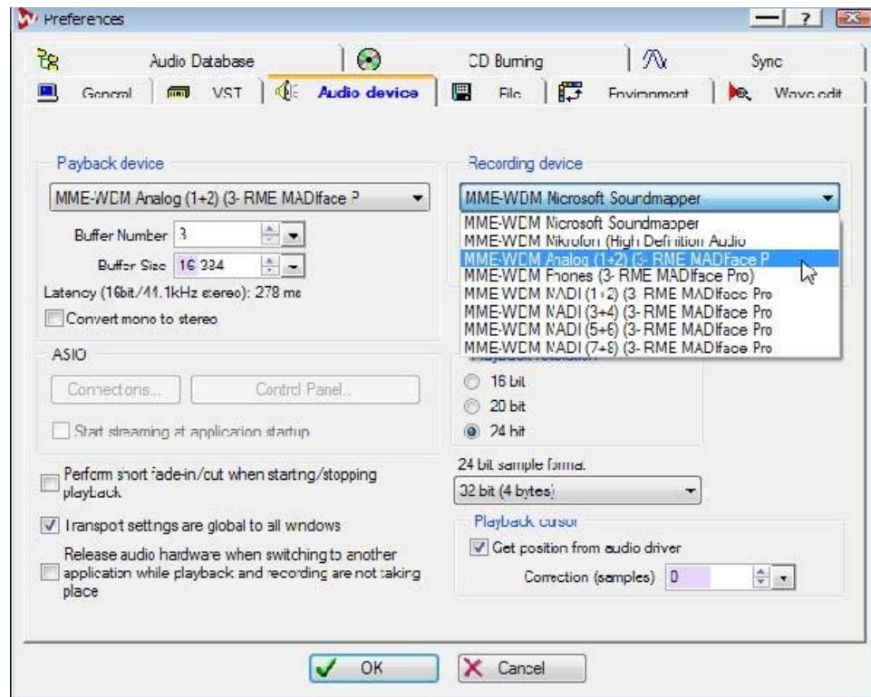
加大缓冲值（Buffer Number）或者缓冲区大小（Buffer Size）能够防止音频数据中断，但是会使延时变长（即输出延迟）。为了实现音频和MIDI等的同步播放，应勾选“Get position from audio driver”（从音频驱动获取位置）。
