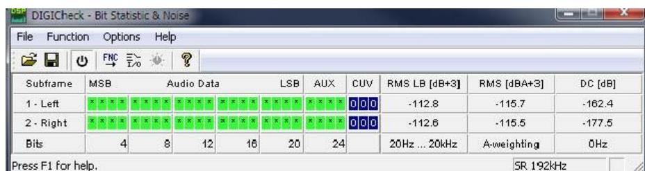
这样的主要原因是模拟数字转换器的噪声整形技术。这种技术可以将所有噪声和失真移至24kHz以上人耳听不到的高频范围。这样做可以得到非常的性能和音频清晰度，但与此同时超声波领域的噪声也会增加。高频噪声具有很高的能量。由于双倍（四倍）带宽，宽频测量设备会显示信噪比骤降，但是在人耳的可听范围内，本底噪声不会有任何变化。
