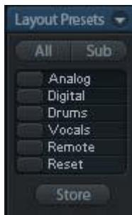
**Sub**键可以启用另一个有用的特殊视图。在**Submix**（子混音）视图中，**Sub**可以使所有通道消失，不再是当前选择的**Submix/Hardware Output**（子混音/硬件输出）的一部分。**Sub**可以暂时显示基于输入行和播放行所有通道的混音，并且不受当前**Layout Preset**（布局预设）的影响。这样便于查看和核实哪些通道被混音/路由到当前的输出。**Sub**可以用于混音的检查和确认，并且使混音编辑本身更方便，即使是在大量通道的条件下也能够保持完整的概览视图。
