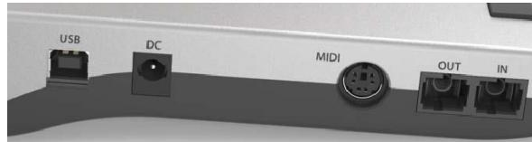
MADIface Pro的左侧有一个MADI光纤输入和输出、一个电源接口、一个USB接口和一个用于连接MIDI辫子线的6-针MIDI DIN接口。
