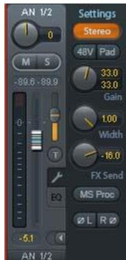
**FX Send (效果发送)**：设置发送到FX总线（用来给回声和混响提供信号）的信号电平。由于旋钮和小推子是同步的，因此关闭通道设置后也会看到当前的设置。为确保该功能得到最佳效果，FX Send被锁定在最高级别的子混音，因此模仿了标准调音台上的“Aux Post Fade”（辅助推子后）功能。拉动大推子时，旋钮和小推子将同时移动。这样做是为了确保混响信号与干信号保持相同的关系。
