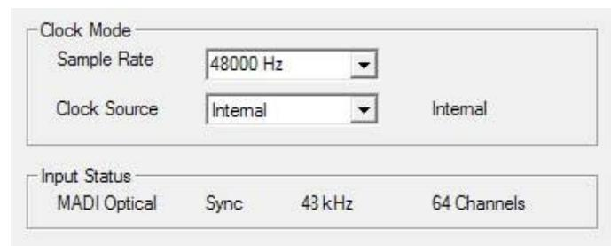
这样，可以容易地配置数字录音所需要的音频应用程序。正确选择输入后，MADIface Pro显示当前的采样率。在应用程序的音频属性对话框(或类似的对话框)中，可以更改该参数。
