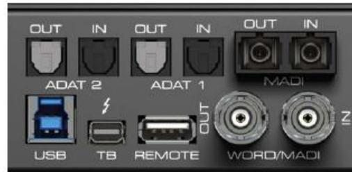
**字时钟输入/输出。** BNC。在Settings（设置）对话框的Input Options（输入选项）中，可将此输入设置成内部75Ohms终止。
