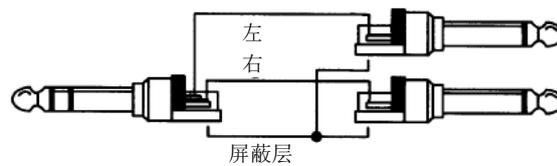
针脚配置符合国际标准。左、右通道分别连接TRS插孔/插座的“尖”和“环”。
